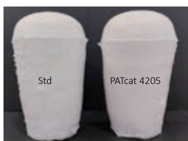
PU Foam 2lbs/ft3 30kg/m3
